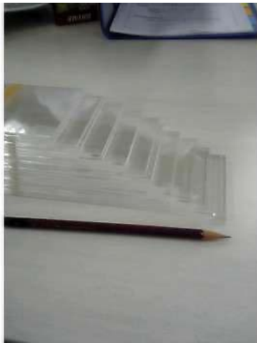
厚さが等しいアクリルの板を階段状に重ねたものをX線で透視撮影.
