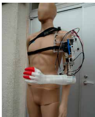
5自由度肩義手 5 DOF Shoulder prosthesis
